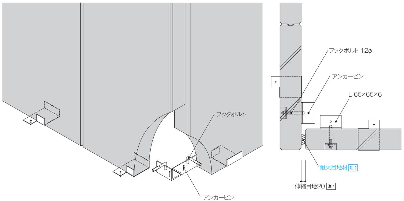
注2 耐火目地材：横目地、出隅、入隅部などの伸縮目地で、耐火構造・断熱など必要な場合は、指定された耐火目地材を充てる。
