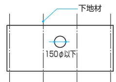
⚠ 加工の径が、150mmを超える場合は、パネル支持材を入れて補強してください。
