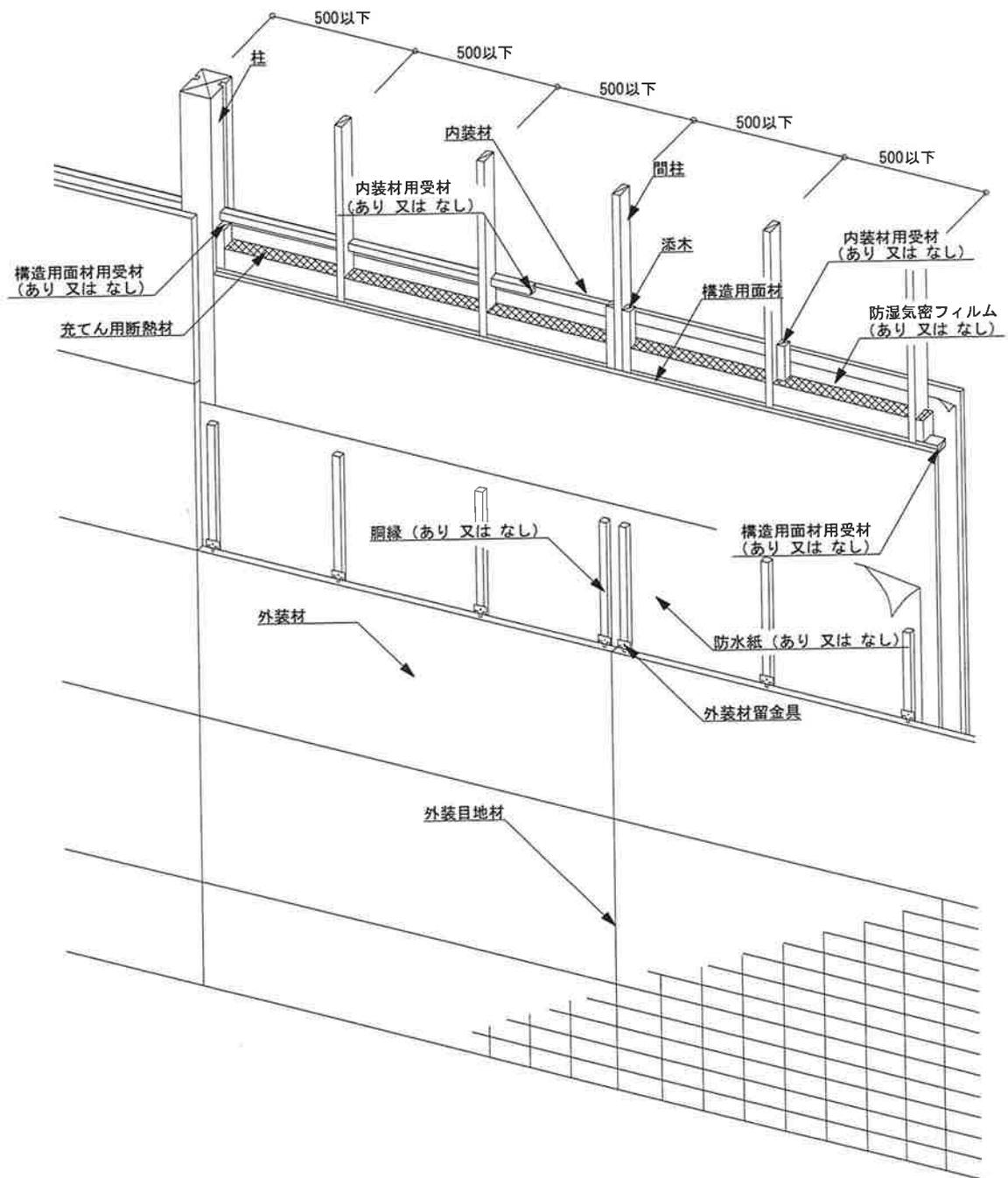
図9 構造説明図 (透視図・構造用面材真壁/内装材真壁①)
