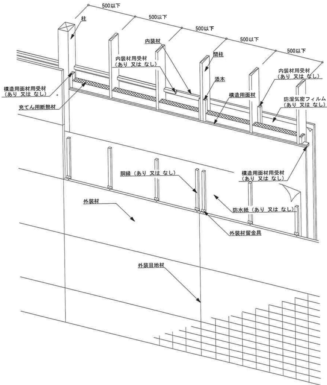
図7 構造説明図 (透視図・構造用面材真壁/内装材大壁)
