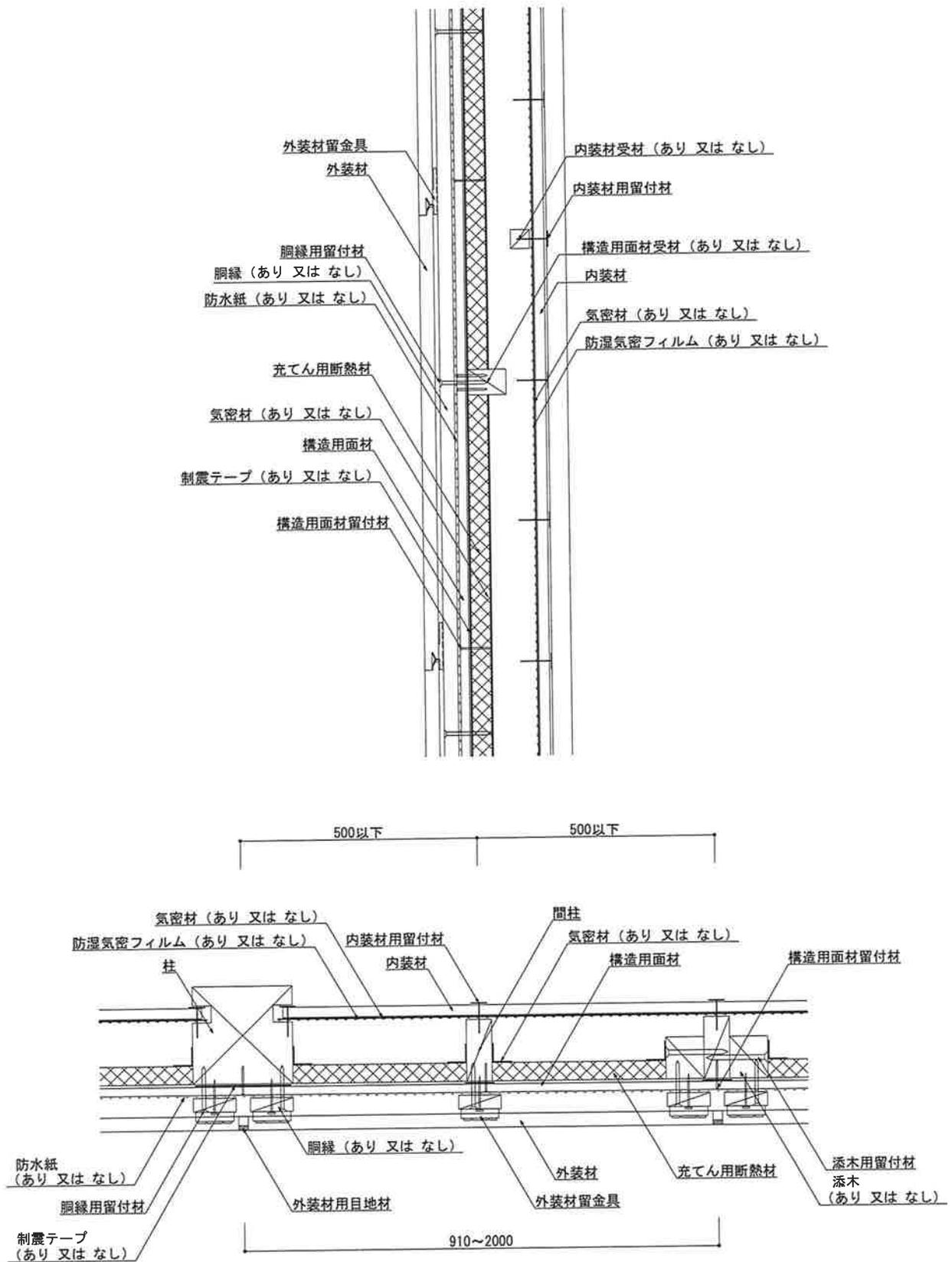
図4 構造説明図 (断面図・構造用面材大壁/内装材真壁①)
