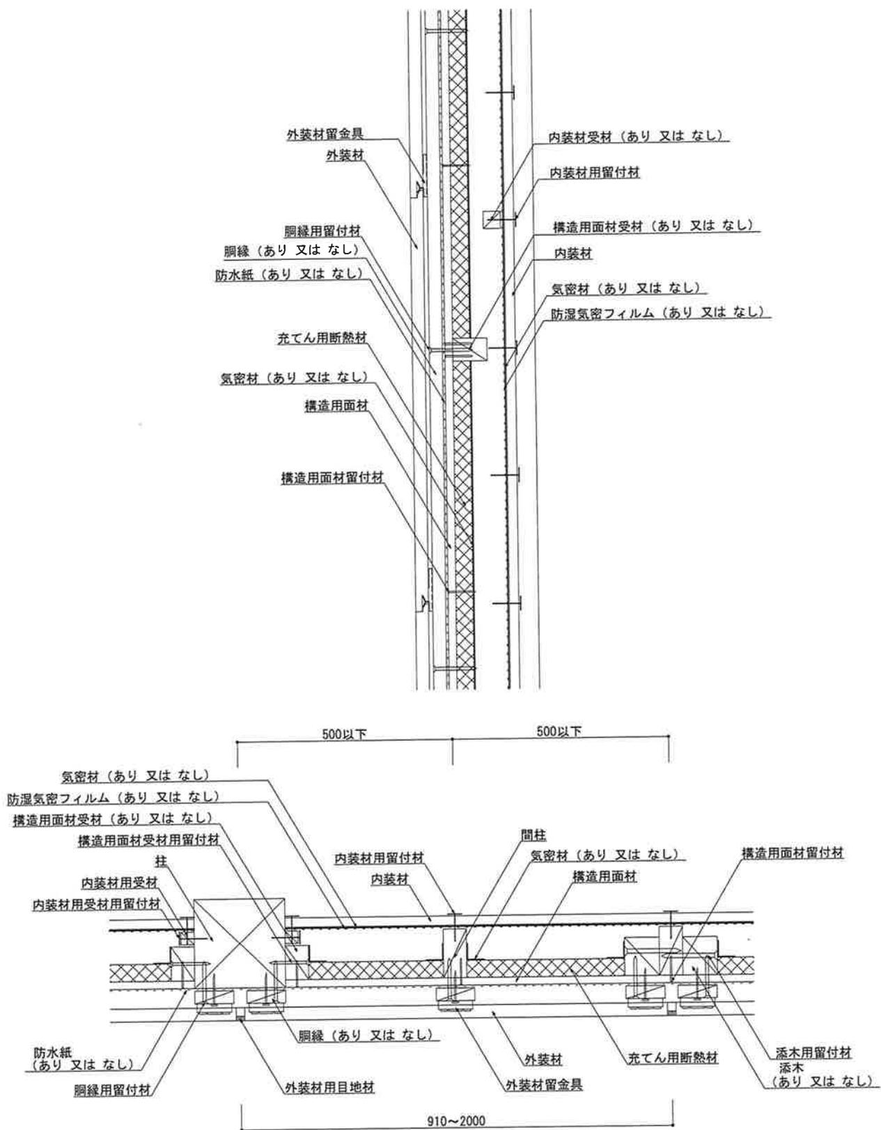
図12 構造説明図 (断面図・構造用面材真壁/内装材真壁②)
