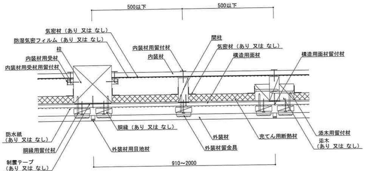
図6 構造説明図 (断面図・構造用面材大壁/内装材真壁②)
