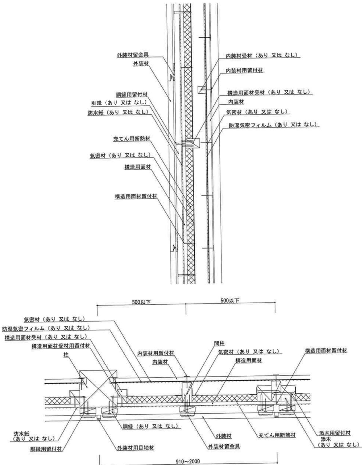
図10 構造説明図 (断面図・構造用面材真壁/内装材真壁①)
