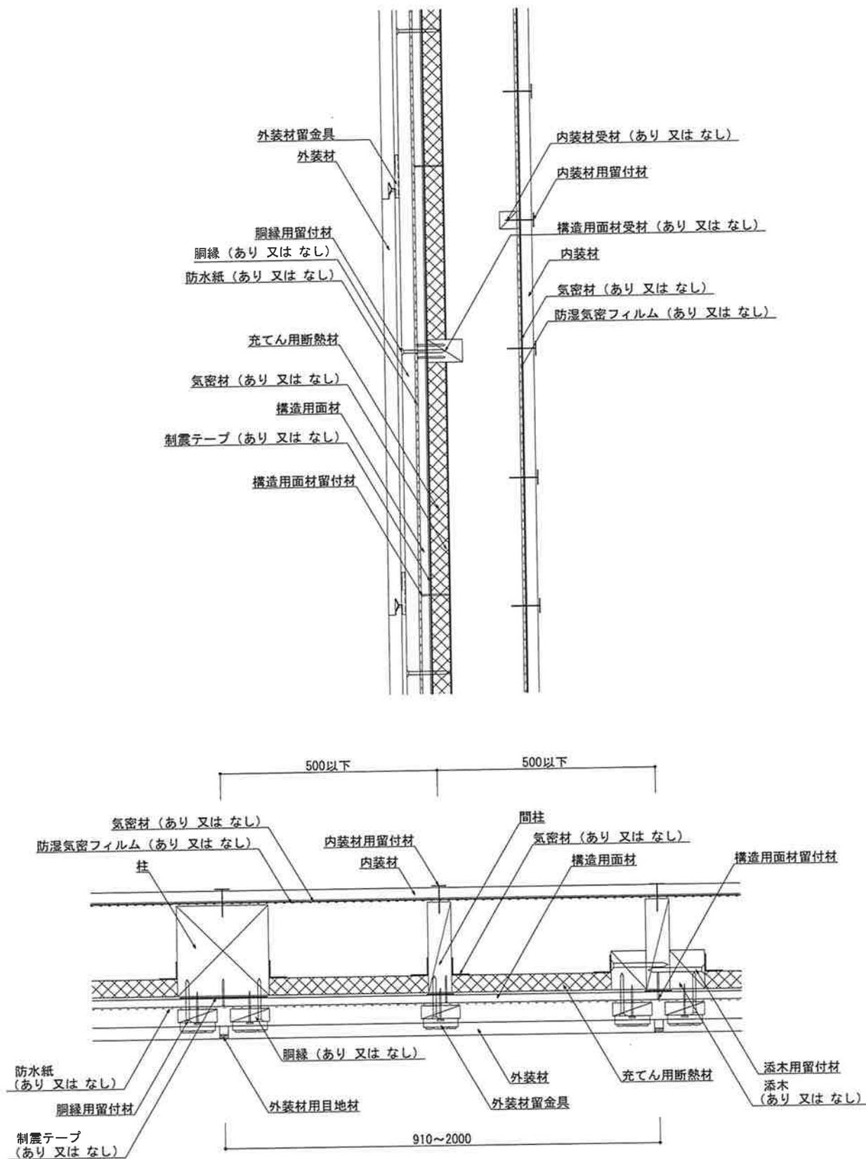
図2 構造説明図 (断面図・構造用面材大壁/内装材大壁)
