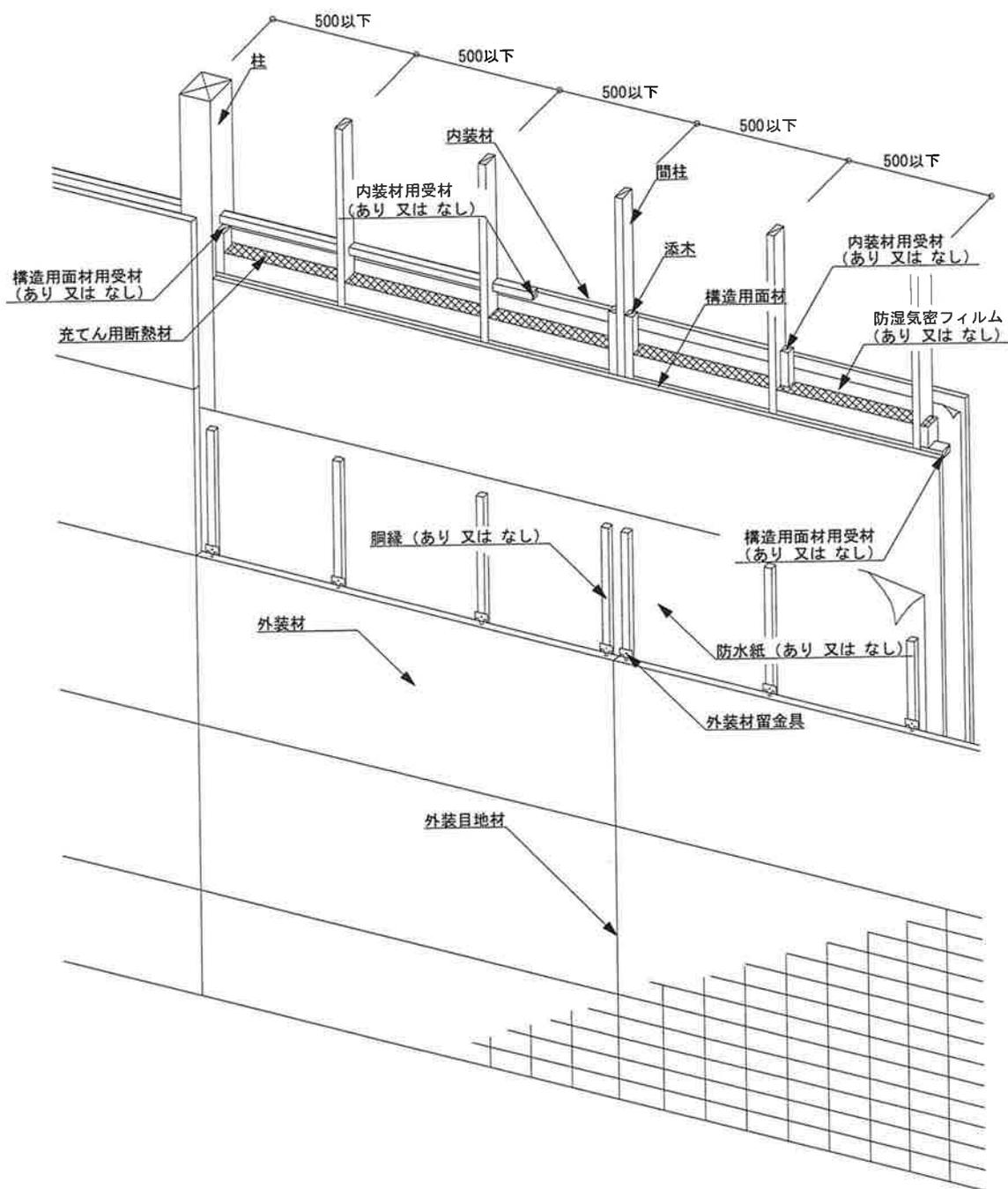
図11 構造説明図 (透視図・構造用面材真壁/内装材真壁②)
