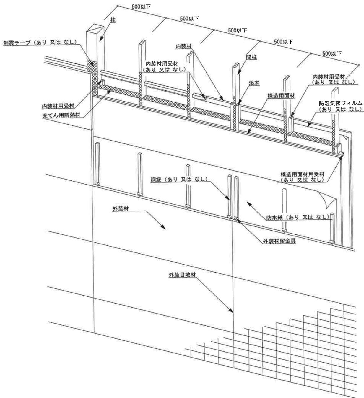
図5 構造説明図 (透視図・構造用面材大壁/内装材真壁②)
