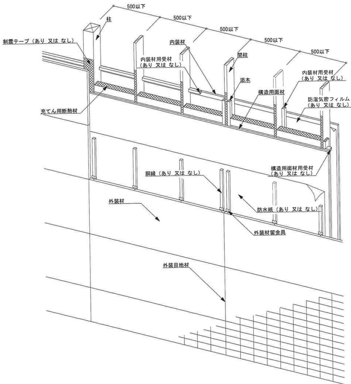
図1 構造説明図 (透視図・構造用面材大壁/内装材大壁)
