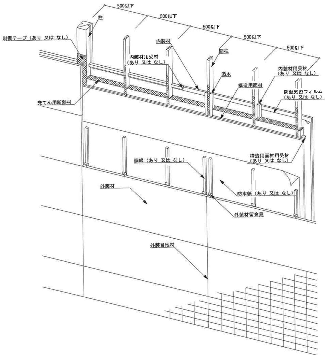
図3 構造説明図 (透視図・構造用面材大壁/内装材真壁①)
