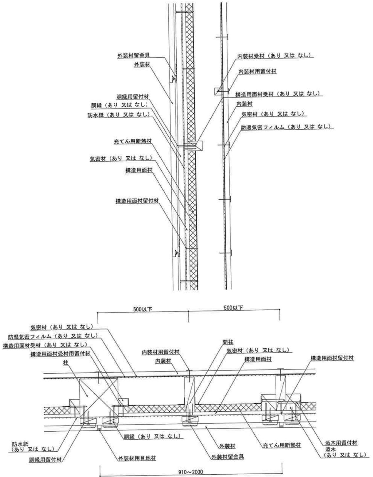
図8 構造説明図 (断面図・構造用面材真壁/内装材大壁)
