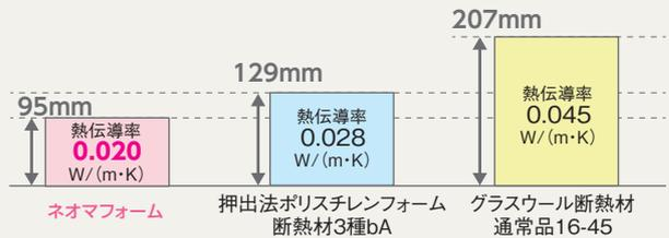
※本比較は、木造住宅の断熱性能等級4の厚さ比較例です。個々のご計画の断熱設計は、個別に実施する必要があります。
